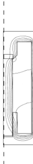
Durch unterschiedliche Formgebung des Ankergegenstückes kann man den Kraft-Weg-Verlauf in gewissen Grenzen beeinflussen und so für viele technische Aufgaben ein besser angepasstes Verhalten des Gleichstrommagneten erreichen.
